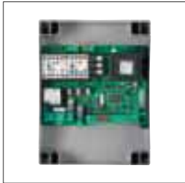
Centrala sterująca dla silnika do mocy 1500W, 230 V jednofazowego i do mocy 2200W, 400V trójfazowego
