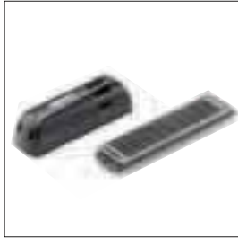
Urządzenie radiowe na częstotliwość 868 MHz. Zawiera: 1 baterię z systemem ładowania dzięki zastosowaniu fotowoltaicznego panela. Wejście na rezystancyjną 8K2 lub mechaniczną krawędź bezpieczeństwa. Charakterystyka produktu na stronie 214
