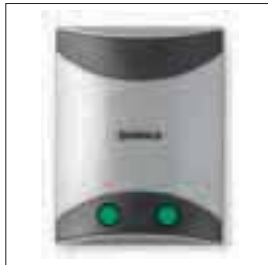
Centrala sterująca dla 1 silnika, idealna do bram przesuwnych, skrzydłowych lub bram przemysłowych. Automatyczne i półautomatyczne sterowanie logiczne. Wyjmowane kostki zaciskowe. Wbudowany odbiornik radiowy (64 kody) 433.92 MHz (Charakterystyka na stronie 152)
